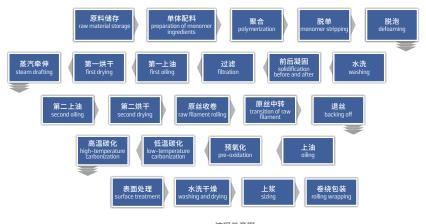
流程示意图 Flow Chart of Preparation
