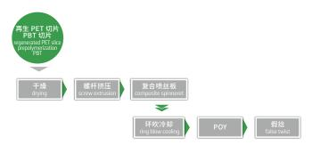
流程示意图 Flow Chart of Preparation
