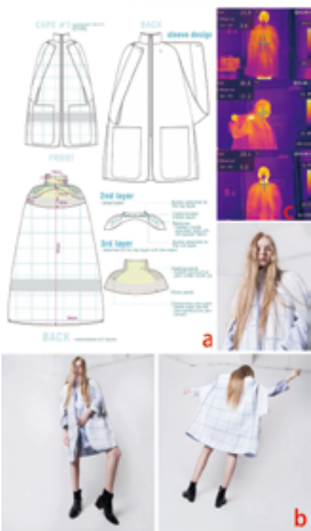
功能性发热服: a 服装设计细节; b 服装设计样品; c 具有颈部加热功能的发热服装, 温度可达 43 摄氏度 (通过红外摄像测得), 用以治疗颈部酸痛。
